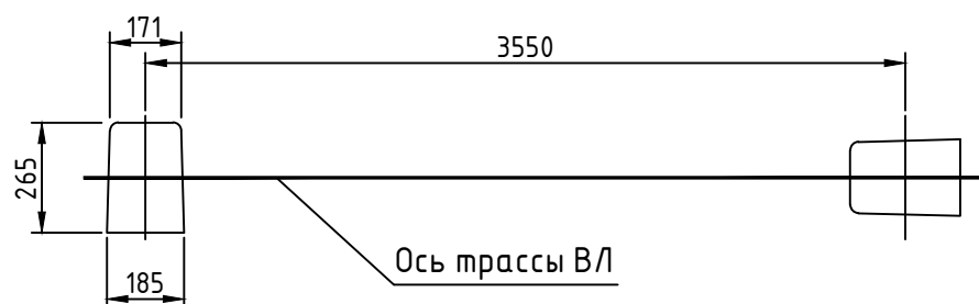
Схема установки стойки СВ 95-3 (СВ 95-2с, СВ 95-3с)
